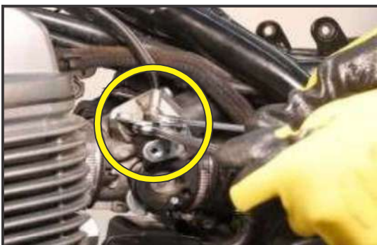
Fig. 1 Cable Mtg. Nuts
